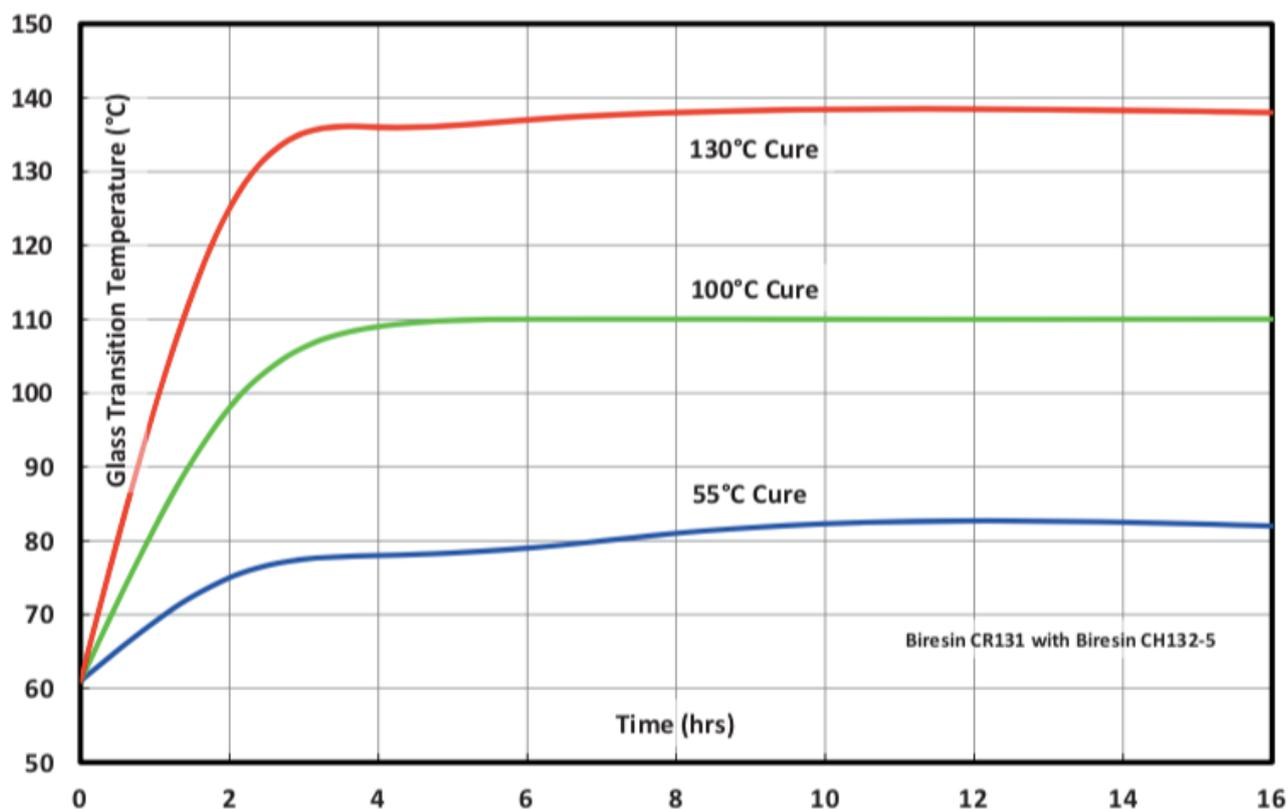
Подходящий цикл отверждения и достижимые механические и термические значения зависят от различных факторов, таких как толщина ламината, объем волокна, реакционная способность системы смолы и т. д. Подходящий цикл отверждения может выглядеть следующим образом:
